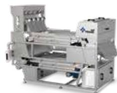
适用于辣椒段、干香菇、蒜片等不规则形状产品，可双层复选，低带出，高选净率。采用AI深度学习算法，模拟人眼视觉机制，高效剔除异物劣品。
