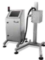
适用于包装类产品的喷码字符检测，可识别喷码字符残缺、喷码标签缺失、喷码重印等质量问题。
