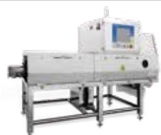
适用于干香菇、豆荚、干辣椒、蒜片、胡萝卜片、西兰花等各类散料，聚合X光、可见光、红外多光谱及AI智能算法，可识别原料内部问题(例：豆荚虫洞、缺粒)及外观问题。
