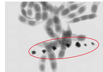
太易 X 光机检测到的毛豆荚中异物
