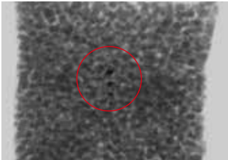
太易 X 光机检测到的包装冷冻蔬菜中异物
