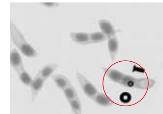
太易 X 光机检测到的毛豆荚中异物
